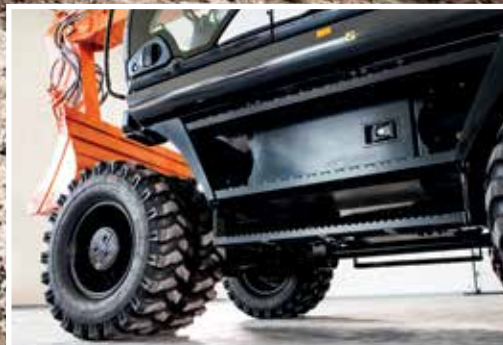
Høy bakkeklaring reduserer skade fra hindringer.
